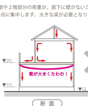
屋根や2階部分の荷重が、直下に壁がないことで、一点に集中します。大きな梁が必要となります。
