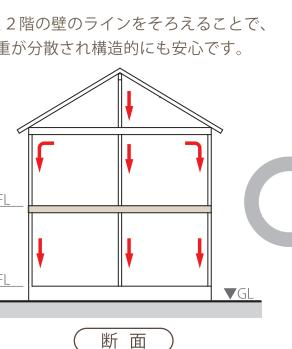
1階と2階の壁のラインをそろえることで、荷重が分散され構造的にも安心です。
